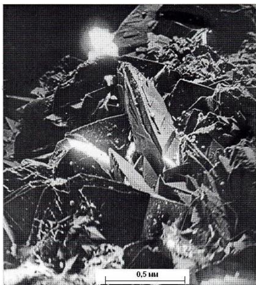
Рис. 2. Друзовидная (поликристаллическая) поверхность мочевого камня. Отчетливо видны многочисленные срастания кристаллов одноводного оксалата кальция (минерал — увеллит). Наблюдения в отраженном свете. Растровый электронный микроскоп РЭМ-200. Ув. 80
